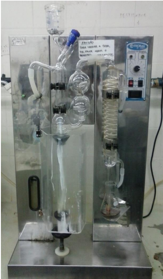
Figura 3. Destilador de nitrogênio amoniacal Tecnal® TE-036/1. (Fonte:Acervo do Autor, 2017).
